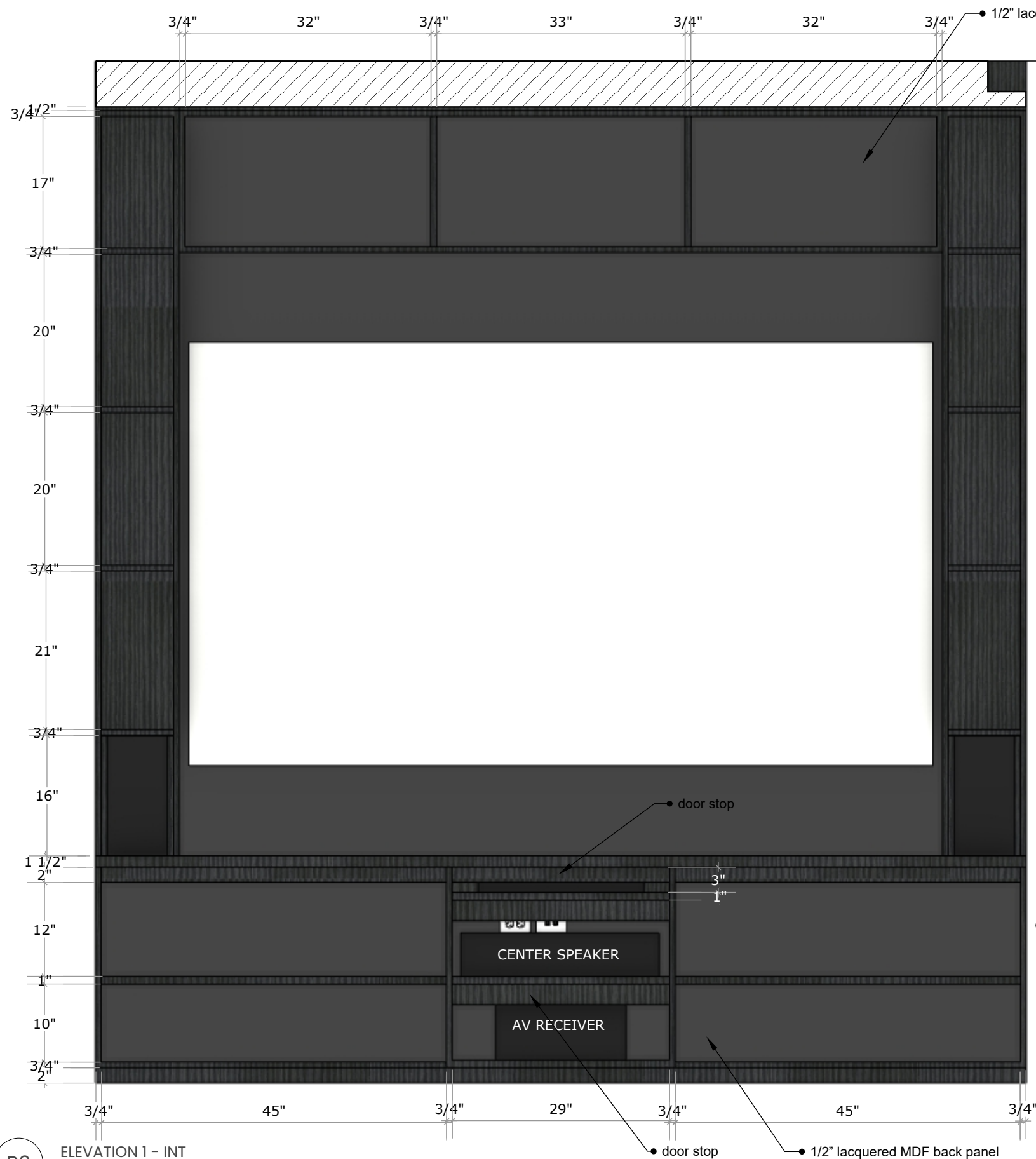
P6 ELEVATION 1 - INT Scale: 3/4"=1'-0"
